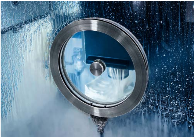
Gehäuse mit integriertem Antrieb und schnell rotierender Glasscheibe im Einbauzustand an einer Werkzeugmaschine. Nur der Abdeckring ist noch aus Metall (Bild: Autz + Herrmann)
